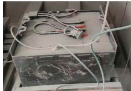
図9 Li-ionバッテリー耐塵密閉試験 Fig.9 Li-ion Battery Dust-Tight Test
