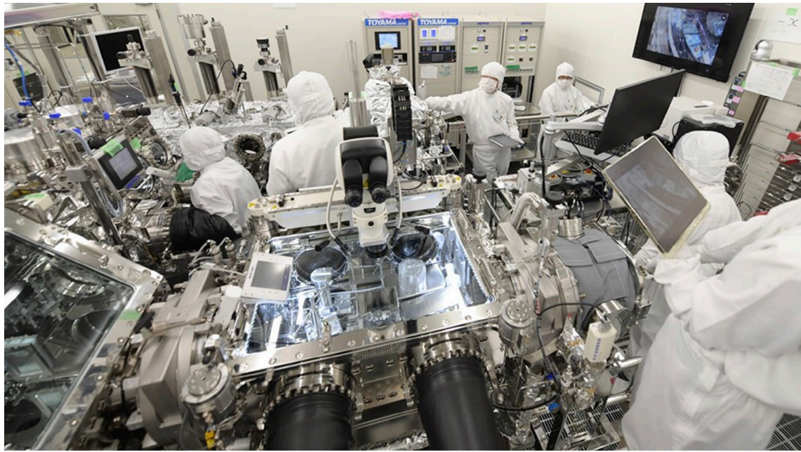
図3 ISASクリーンルームに設置された、はやぶさ2クリーンチャンバーとそこで作業するキュレーションスタッフ
