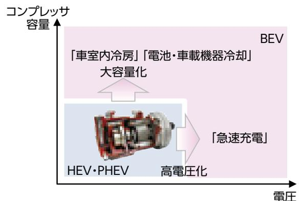
図4 電動コンプレッサの高電圧化・大容量化の拡充
