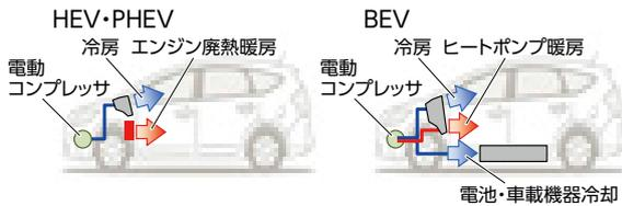
図3 電動コンプレッサに求められる機能の拡大
