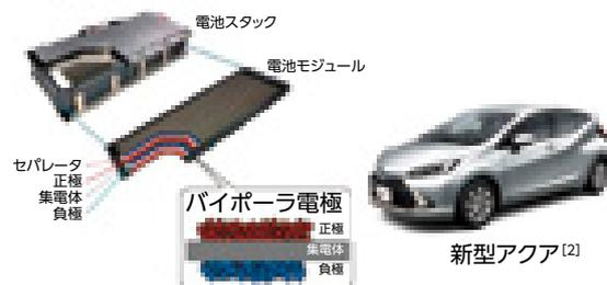
図2 バイポーラ型NiMH電池と搭載車両
