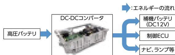
図1 DC-DCコンバータの機能
