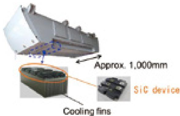
図5 N700Sの主変換装置
