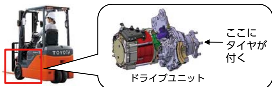
図1 ドライブユニットの取り付け位置 Fig.1 Mounting Position of the Drive Unit
