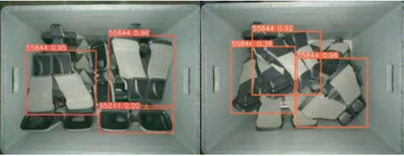
図8 YOLOv8による対象部品特定の例 Fig.8 Example of Part Identification Using YOLOv8
