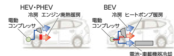
図3 電動コンプレッサに求められる機能の拡大 Fig.3 Expanding the Functions Required of Electrical Compressor
