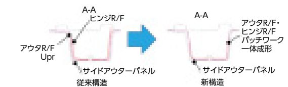
図3 センターピラー断面 Fig.3 Section of Center pillar
