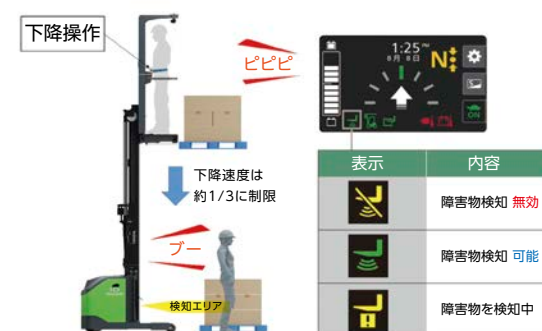
図7 下降スマートアラームの機能概要 Fig.7 Overview of Lowering Smart Alarm
