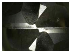
図11 刃先摩耗(最適化前) Fig.11 Tool Tip (Before)
