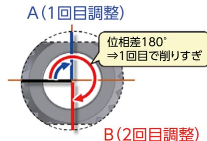
図11 1回目調整で削りすぎの場合
