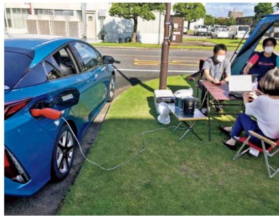
図3.7 ACインバータの使用状況
