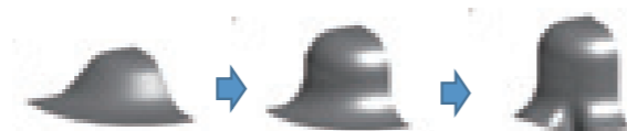
図2 成形によるプレス品不具合(座屈) Fig.2 Defect of the pressing panel(Wrinkle)
