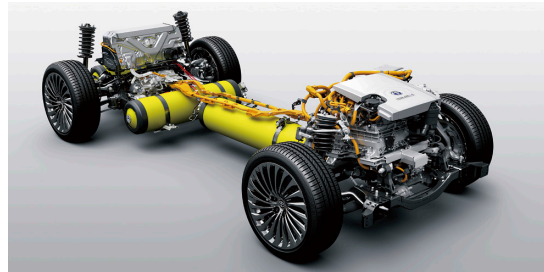
図3 MIRAIに搭載されているCFRP製高圧水素タンク [2] Fig.3 CFRP High Pressure Hydrogen Tank on the MIRAI
