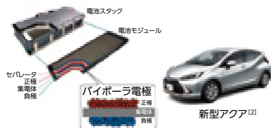
図2 バイポーラ型NiMH電池と搭載車両 Fig.2 NiMH bipolar battery and equipped vehicle
