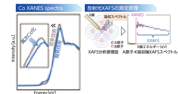
図12 NiMH正極活物質に対する放射光XAFS分析 Fig.12 XAFS spectroscopy for active material of NiMH positive electrode
