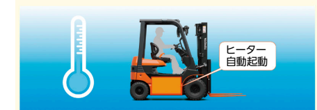
図12 バッテリー内蔵ヒーターによる車両制御イメージ [3] Fig.12 Image of Vehicle by Battery-Integrated Heater
