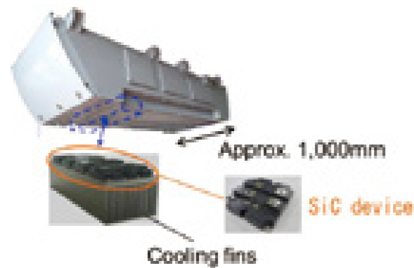
図5 N700Sの主変換装置
