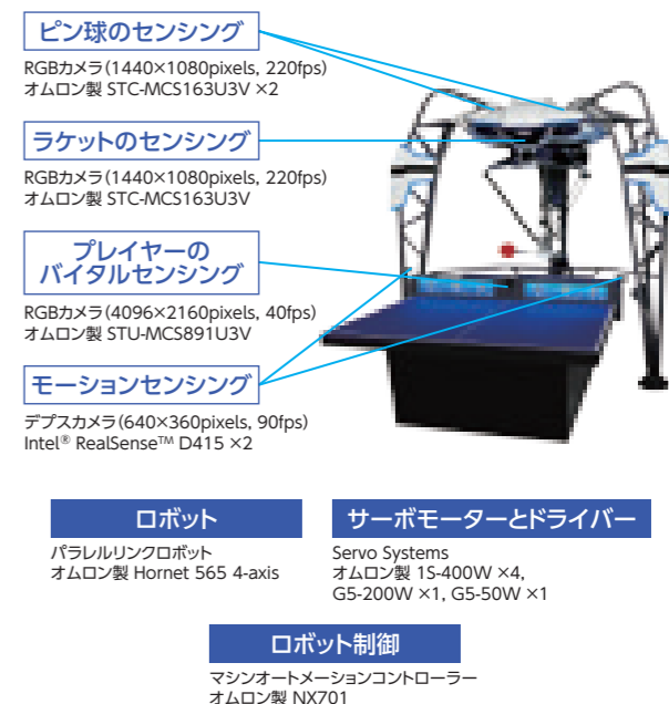
図1 フォルフェウスの概略構成
