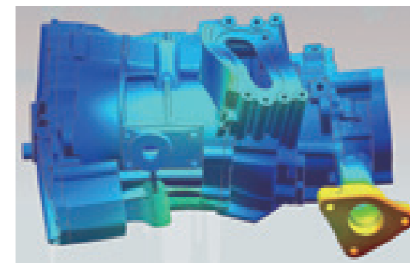
図12 エアコンプレッサのモーダル解析 Fig.12 Modal Analysis in assembly
