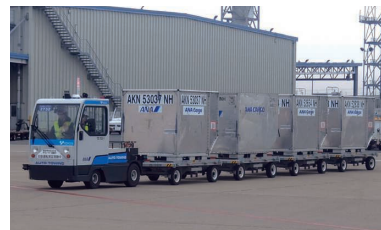
▲中部国際空港でのトーイングトラクター自動走行実証実験
