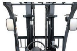
形状の変更により 広い前方視野を確保したマスト
