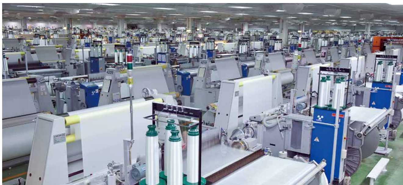
JAT710の稼働する南亜プラスチック社の工場
