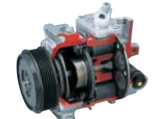
7SEU17 コンプレッサー (斜板式クラッチレス外部可変容量)
