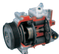
7SEU17 コンプレッサー (斜板式クラッチレス外部可変容量型)
