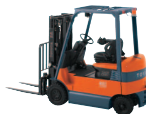
Toyota 7FBMF25 カウンタータイプバッテリー式 フォークリフト (80V)
