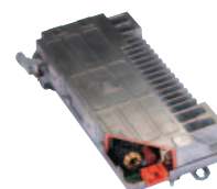
LS600h 搭載 EPS 用 DC-DC コンバーター
