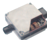
LS460 搭載 EPS 用 DC-DC コンバーター
