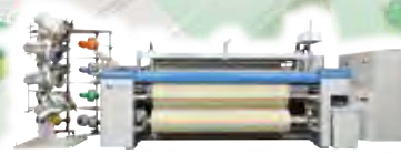
よこ糸を空気で飛ばし、 さまざまな風合いの織物の 製織が可能な エアジェット 織機
