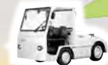
空港内で活躍する 環境に優しい電動タイプの トレーイングトラクター
