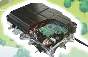
ハイブリッド車の電圧を変換し ライト、ワイパーなどの 使用を可能にする
