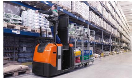
リチウムイオン電池搭載車
