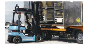
自動運転フォークリフトの実証実験
