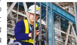
ワイヤロープ内部破断調査
