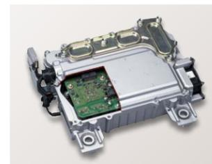
プリウス搭載四輪駆動用リヤ走行インバーター
