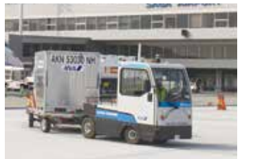
トーイングトラクターの自動走行テスト
