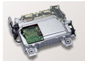
プリウス搭載四輪駆動用リヤ走行インバーター
