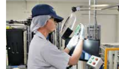
エレクトロニクス事業部での基板検査
