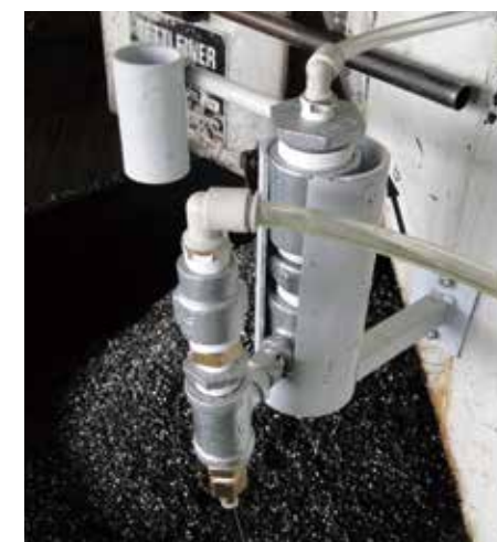
岩間織機製作所での部品加工ゼロに进化させた「からくりポンプ」
