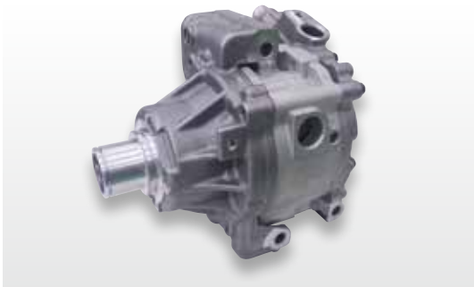
SCSE06コンプレッサー(スクロール式固定容量タイプ)
