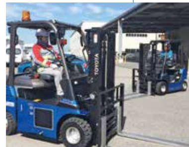
燃料電池フォークリフトの実証実験
