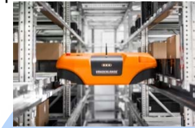
シャトルタイプ 自動倉庫
