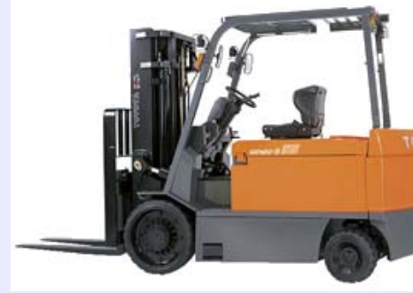
大型電動式フォークリフト (5.5トン~8.5トン) GENEO-B HTC (09/9月発売)
