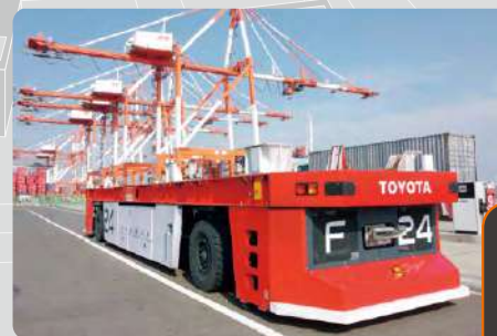
コンテナ搬送AGVシステム
