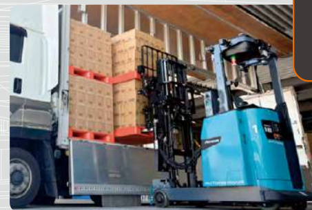
自動運転フォークリフト
