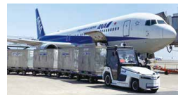
図2：自動運転トーイングトラクター
