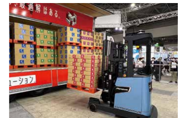
トラック荷役対応自動運転フォークリフト
