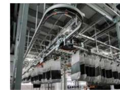
吊り下げ式高速仕分けシステム
