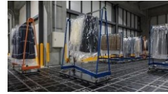
③ビームス納入のリニアモーター式ロボット「CUEBUS（搬送タイプ）」
