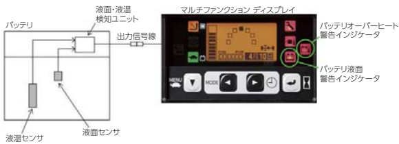
図6 システム構成図 Fig.6 System Configuration
