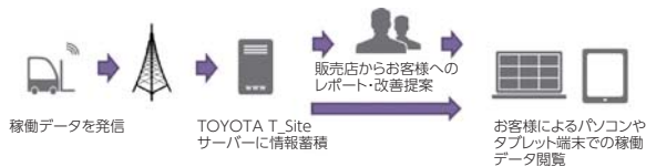
図9 情報の流れ Fig.9 Flow of information
