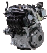
M20A-FKS型 排気量2.0ℓ RAV4、ハリアー搭載
