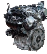
A25A-FKS型 排気量2.5ℓ RAV4搭載
