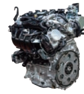
A25A-FKS型 排气量2.5L 搭载于RAV4荣放
