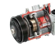
7SES17 斜板式无离合器 外部可变容量
