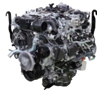
F33A-FTV型 排气量3.3L 搭载于兰德酷路泽车300
