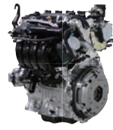
M20A-FKS型 排気量2.0 ℓ RAV4、ハリアー搭載
