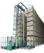
TOYOTA ユニット式パレット用自動倉庫 Rack Sorter P
