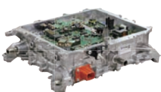
車載充電器・ DC-DCコンバーター 一体ユニット
