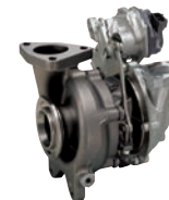
GD型エンジン用 可変ノズル式
