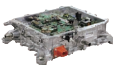
车载充电器、 DC-DC转换器 一体单元
