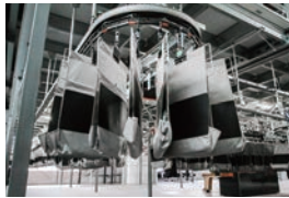
VANDERLANDE 垂直式高速分拣系统 POCKET SORTER
