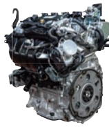
A25A-FKS型 排气量2.5L 搭载于RAV4荣放
