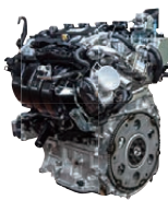
A25A-FKS型 排気量2.5ℓ RAV4搭載
