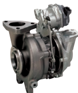
GD型エンジン用 可変ノズル式
