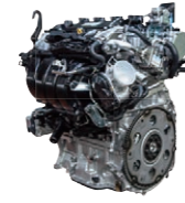
A25A-FKS型 排気量2.5ℓ RAV4搭載
