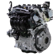
M20A-FKS型 排気量2.0ℓ RAV4、ハリアア搭載
