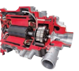
エアコンプレッサー MIRAI搭載
